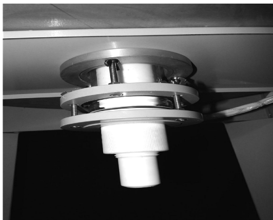
图 3 下放料口安装结构
